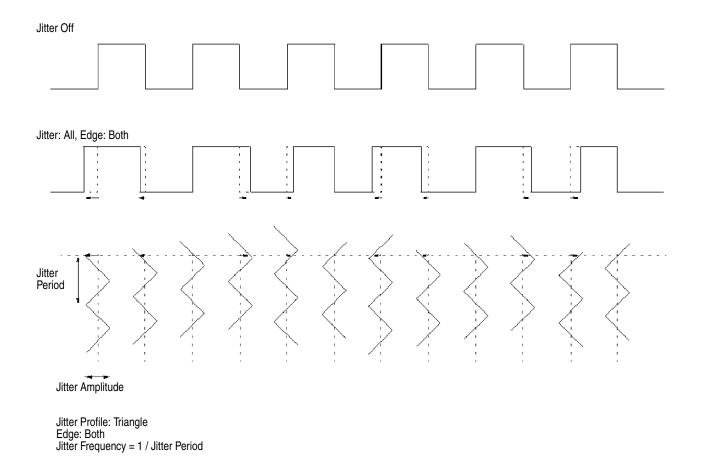
Figure 1-50: Jitter Generation parameters
